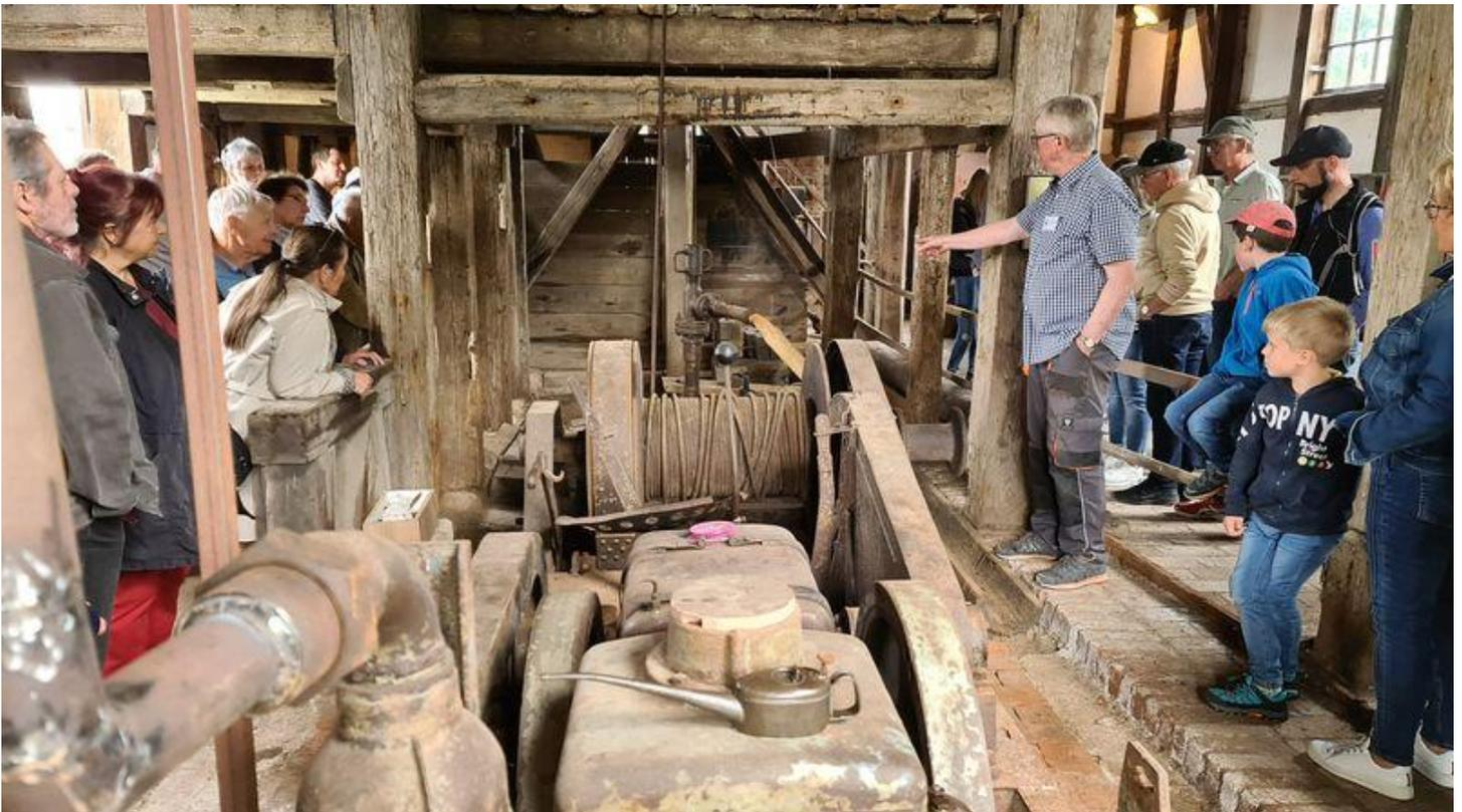
In dem hallenartigen Fachwerkgebäude mit herausragendem quadratischem Bohrturm ist die Ausrüstung vollständig in technisch funktionsfähiger Form erhalten.
